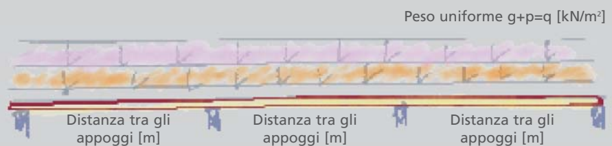
Sostegno a tre campate g+p = q per L/400 freccia non puntuale g/p = 0,5 fino a 1,5
